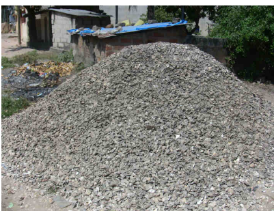
Les coquillages sont utilisés pour solidifier le béton
